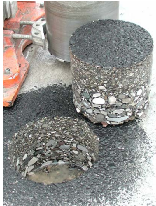
Fig. 13 - Il campione non rinforzato macchina
